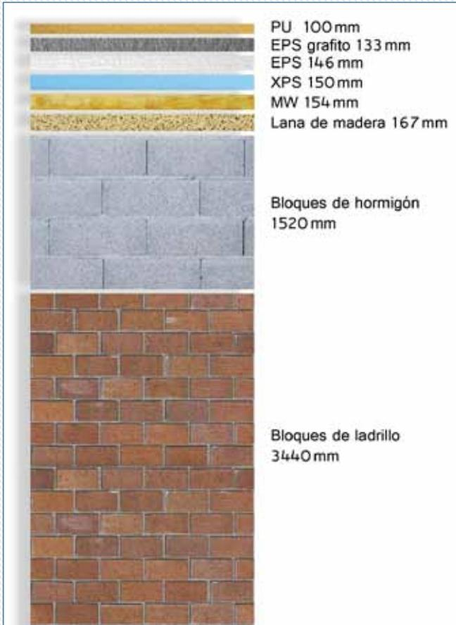
Figura 2: Espesor de los diferentes aislantes y otros materiales para valores de R iguales
