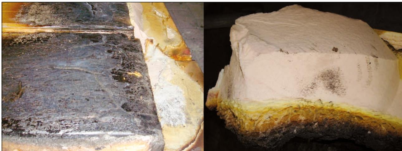
**Figura F3.1.** Ejemplo de la extensión de la carbonización sobre una espuma rígida de poliuretano.
