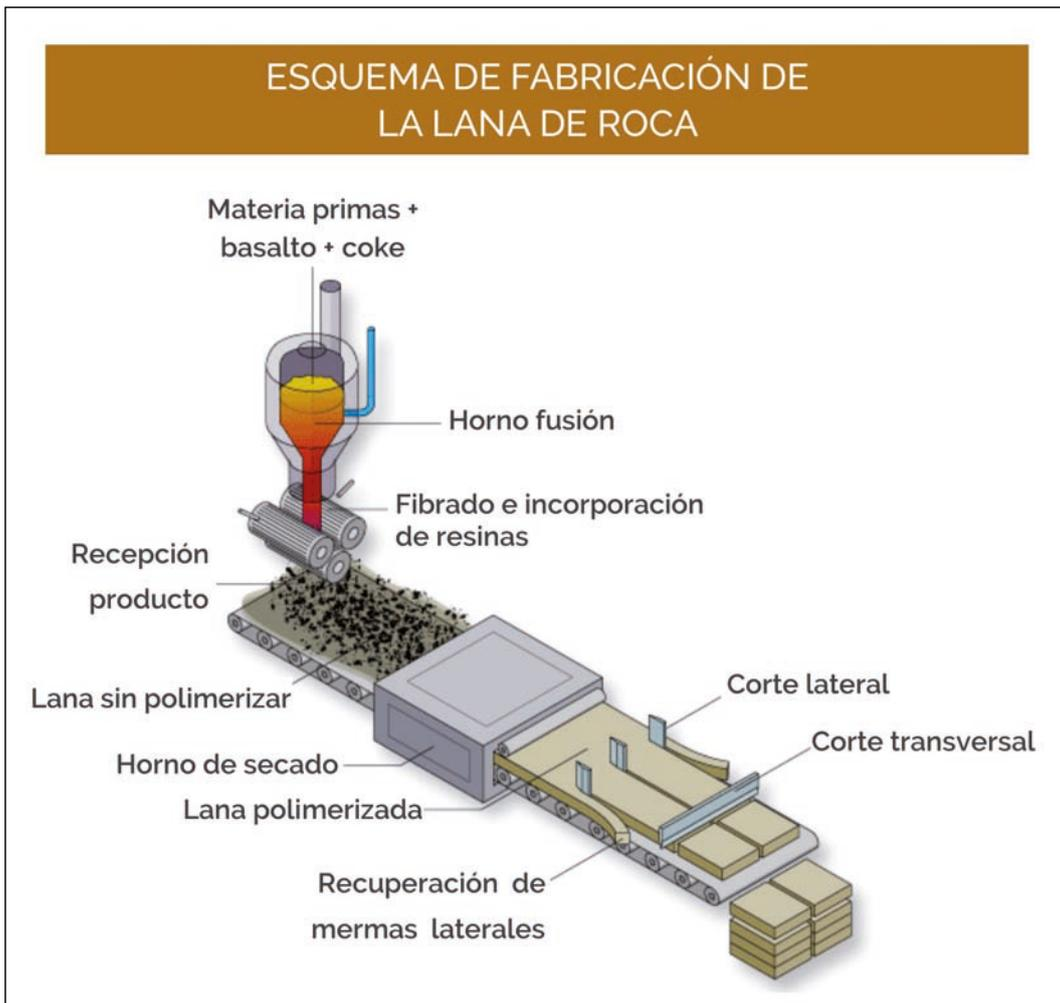
Figura F2.3. Proceso de fabricación de la lana de roca. Fuente: Cortesía de AFELMA
